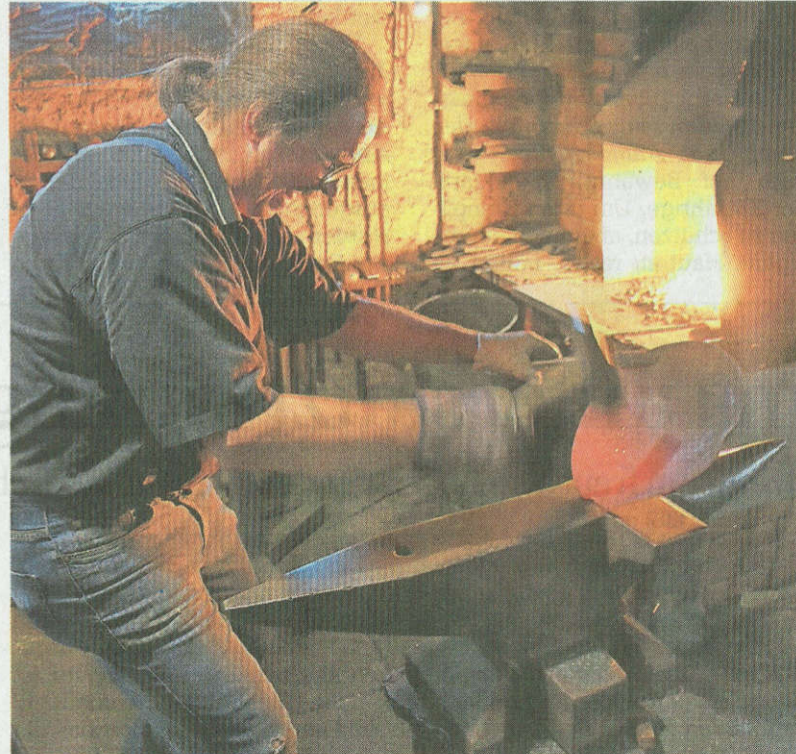
Wolfgang J. Krauss-Schleissner bearbeitet die glühende Halbschale am Amboss mit dem Hammer. Eine der fünf neuen „Klangblüten“ ist bereits fertiggestellt – und klingt.
